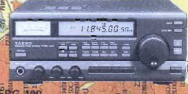
FRG 100 Ricettore multimodo HF (da 50 KHz a 30 MHz) Alta sensibilità e ottima conversione in SSB, CW, AM, FM, 50 memorie
